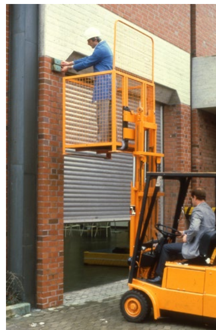
Abb. 4-5 Flurförderzeug mit Arbeitskorb
