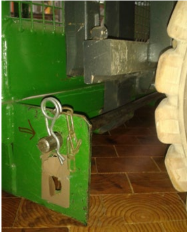
Abb. 4-6 formschlüssige Sicherung gegen Abrutschen
